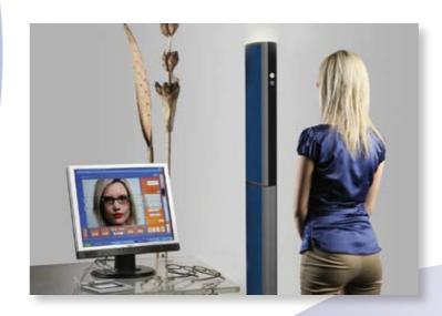
Strumento ideale per supportare l'ottico optometrista nella sua attività professionale e di marketing. Il software, fornito in abbinamento con lo specchio, guida facilmente nella scelta della montatura, simula tridimensionalmente le lenti, calcola la distanza interpupillare, le altezze di montaggio e, per le lenti progressive di ultima generazione, viene rilevato l'angolo pantoscopico e la distanza apice corneale - lente.
